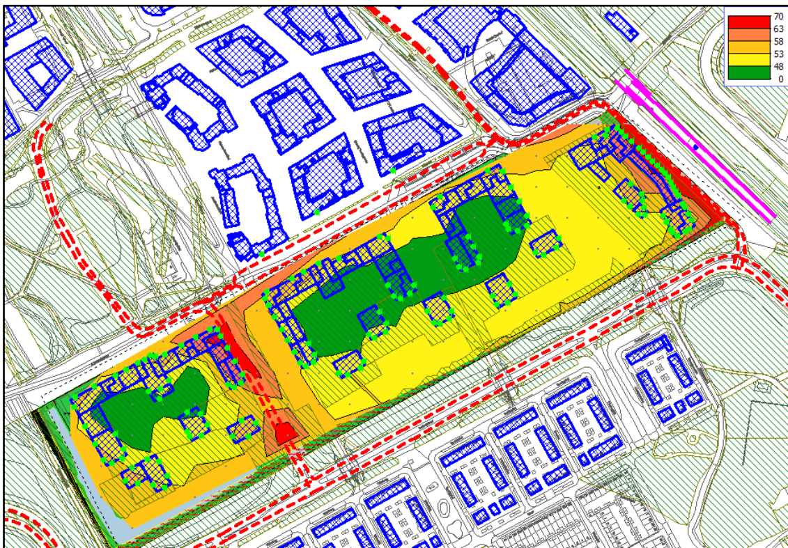
Figuur 6.8 Ligging gecumuleerde geluidcontouren wegverkeerslawaai (toetshoogte 1,5 meter)
