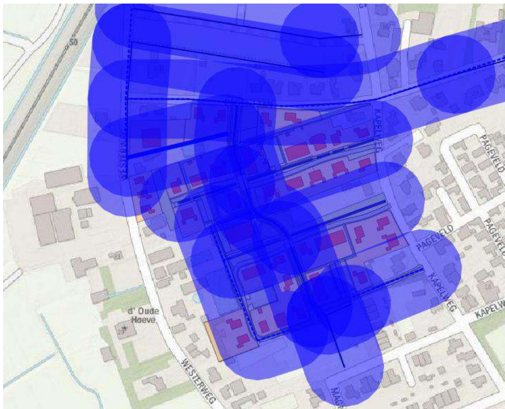
Figuur 7 Afstand tussen ontwaterende voorziening (max. 80 m)
