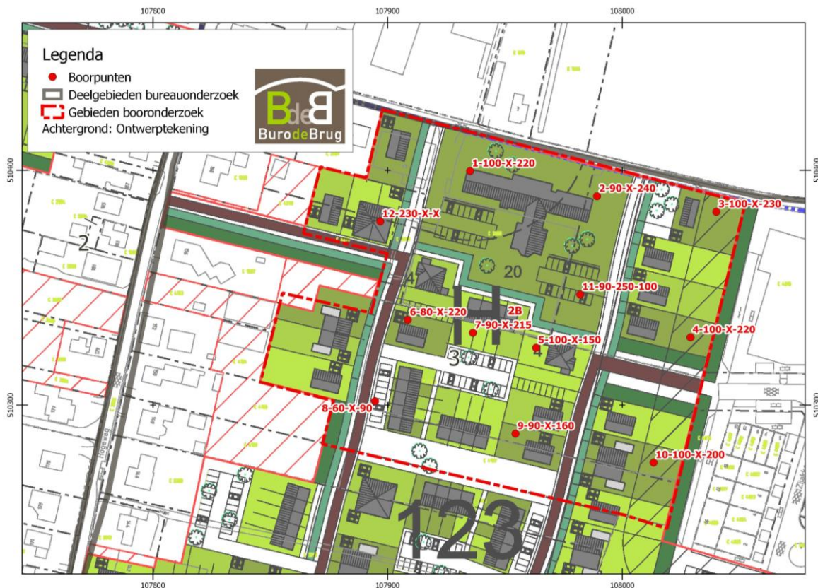
Afbeelding 10: Locatie bodemprofielputjes en boringen binnen bouwlocatie 2B. De labels geven achtereenvolgens het boornummer, diepte van de verstoring, diepte eventuele veenlaag en diepte eventuele archeologische laag (vegetatiehorizont). Onderzoeksgebied 2B is omkaderd met een rode stippellijn.
