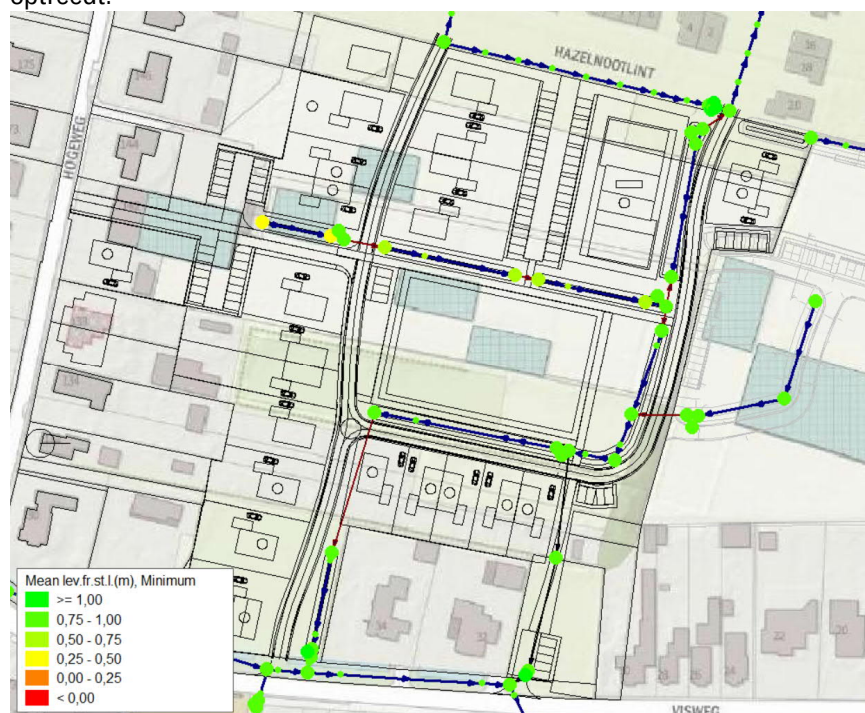
Figuur 7 Maximaal berekende waterstand ten opzichte van maaiveld bui8
