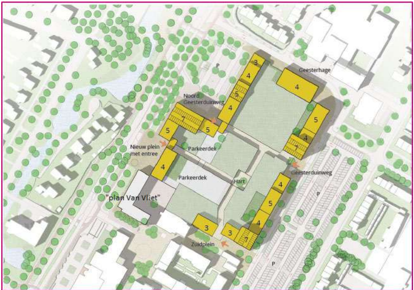
Figuur 3: Schematische weergave aantal verdiepingvloeren
