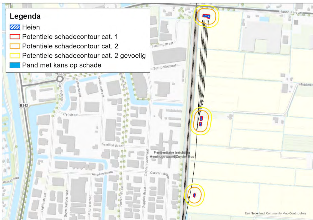
Figuur 72 Schadecontouren opstelsterrein Heerhugowaard De Vaandel
