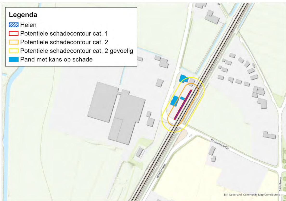
Figuur 71 Schadecontouren en panden met kans op schade bij geluidscherm Westerweg/Dronenlaantje
