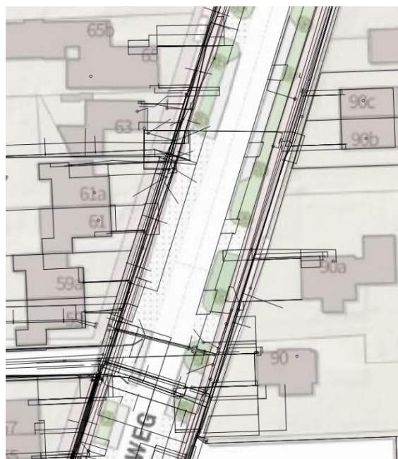
Figuur 2 Kabels en leidingen
