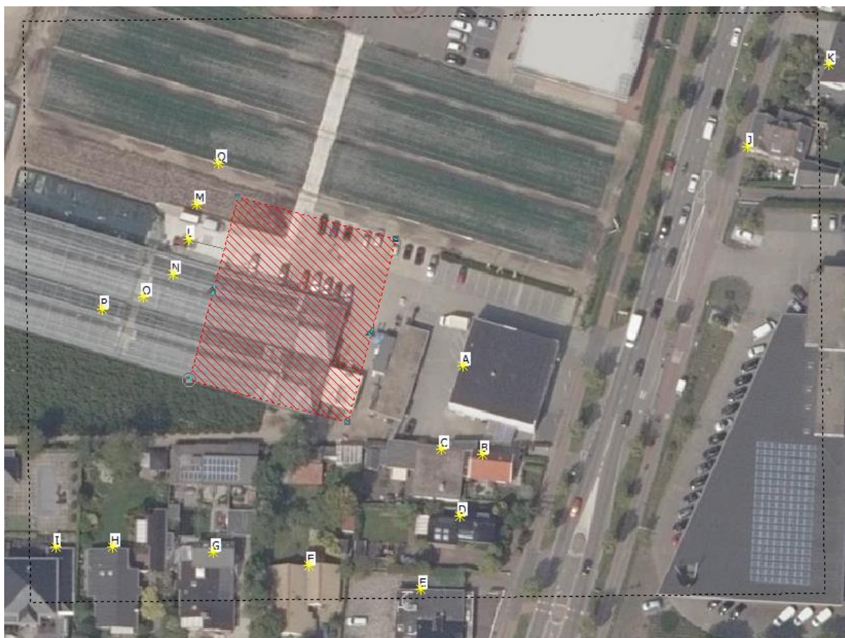
Figuur 5.2 Modellering van de emissie van gewasbeschermingsmiddelen bij Cristian Schilder als oppervlakte bron met een hoogte van 2,5 m (rood gearceerd) en de gehanteerde toetspunten (A t/m Q).
