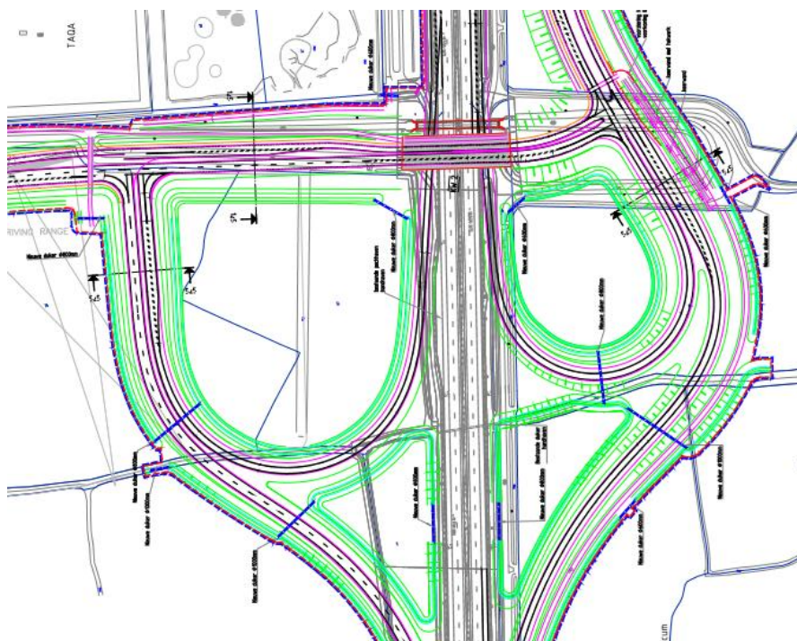
Figuur 10: Situatie met kopsloten en het oplossen daarvan door middel van duikers (blauwe lijn = verbinden watergang middels een duiker)
