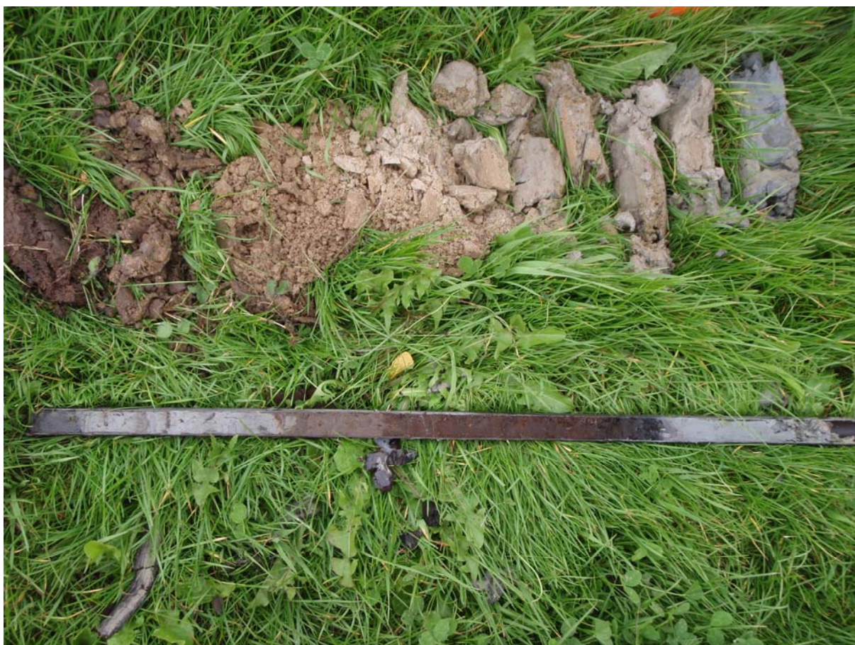
Afb. 3: Resultaat boring 014 (Startingerweg). De verlanding van het getijdesysteem, vervening en veraarding van de top van het veen alsmede de aansluitende overstroming van het gebied is in deze boring duidelijk zichtbaar. De eerste meter is met een Edelmanboor (diameter 7 cm) geboord, de tweede meter met een guts (diameter 3 cm).
