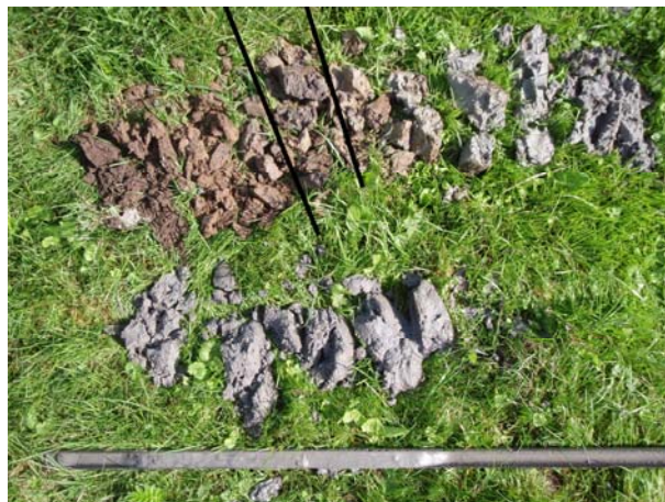
Afb. 2d: Resultaat van boring 003 (Korte Brakersweg) met mogelijke leeflaag op een diepte van 40-50 cm -mv (tussen de zwarte lijnen).
