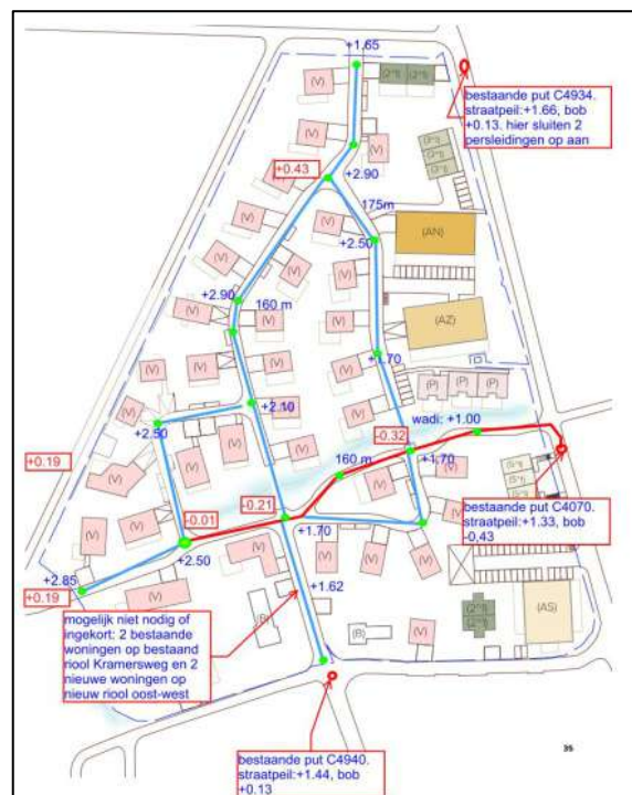
Figuur 13: Schetsvoorstel vuilwaterriool door gemeente [8].
