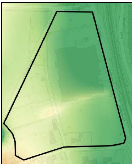
Figuur 7: Grondwaterstanden in het grondwatermodel (groen = lager, geel/oranje = hoger)
