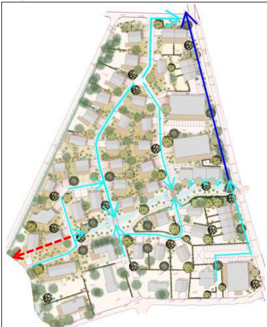
Figuur 12: Schetsvoorstel hemelwaterriool (lichtblauw hwa, donkerblauw overstortriool naar oppervlaktewater). Met de rode pijl wordt een mogelijke toekomstige afvoer richting Zanderij Noord aangeduid (locatie en dimensionering eventueel nader te bepalen).
