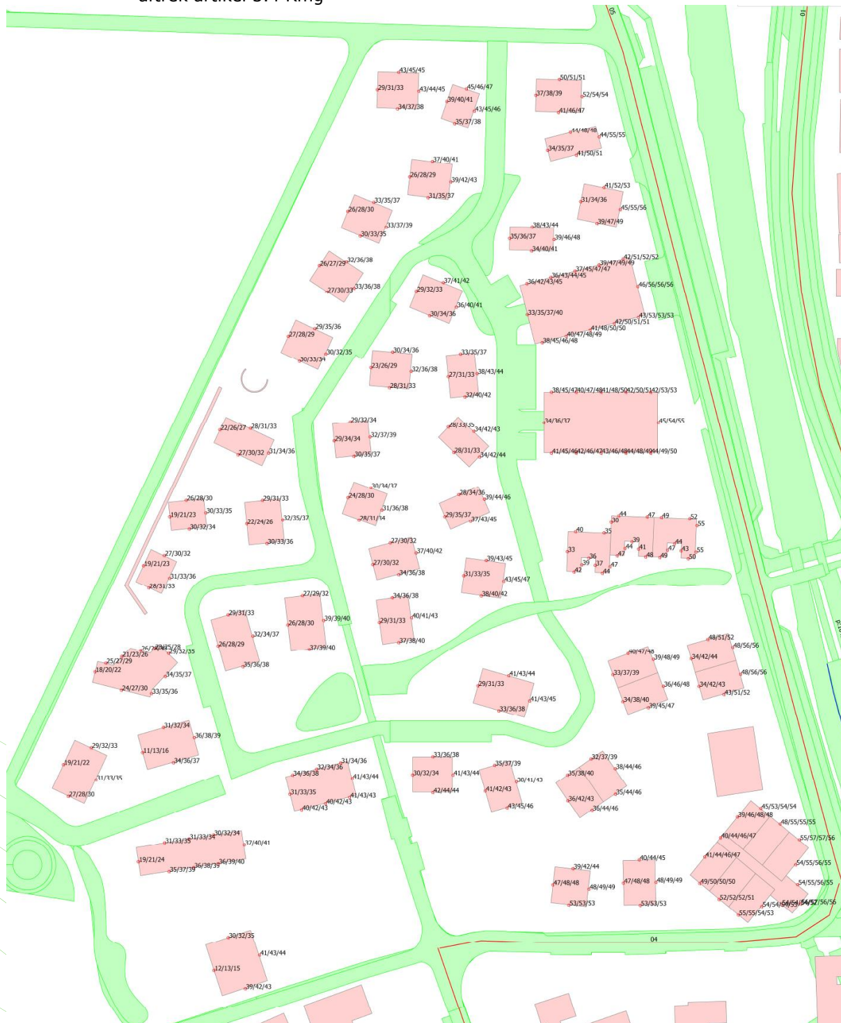
Figuur 10 Groep 1: Berekeningsresultaten Stationsweg/Mient 50 km/u inclusief 5 dB aftrek artikel 3.4 Rmg
