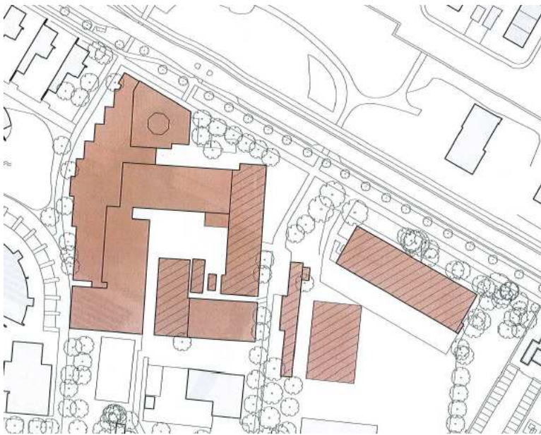
Fig. 1. Plangebied met daarin de te slopen bebouwing gearceerd weergegeven.
