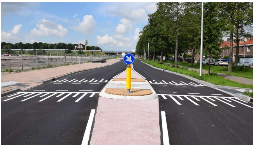
4.8 Voorbeeld van het principe van de oversteeklocatie met een middengeleider
