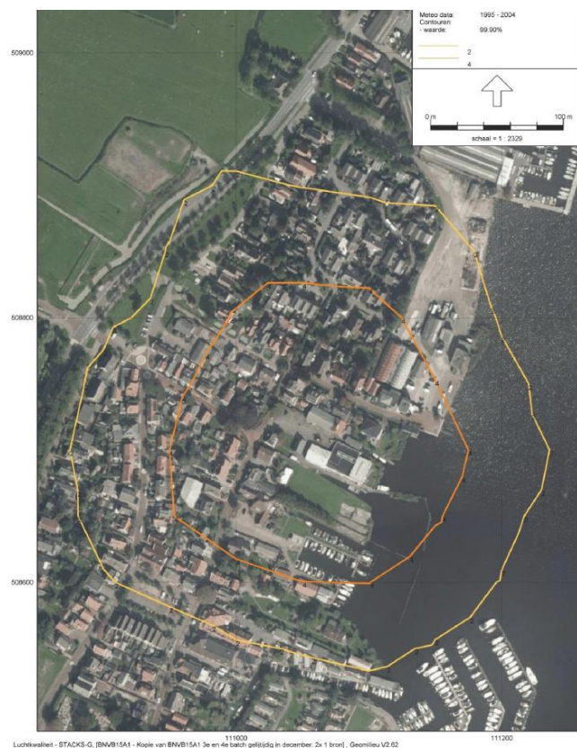
Geurcontouren van 2 \text{ ouE(H)/m}^3 als 99,9-percentielwaarde (geel) en 1 \text{ ouE(H)/m}^3 als 99,9-percentielwaarde (oranje) als gevolg van de geuremissie van DilVis
