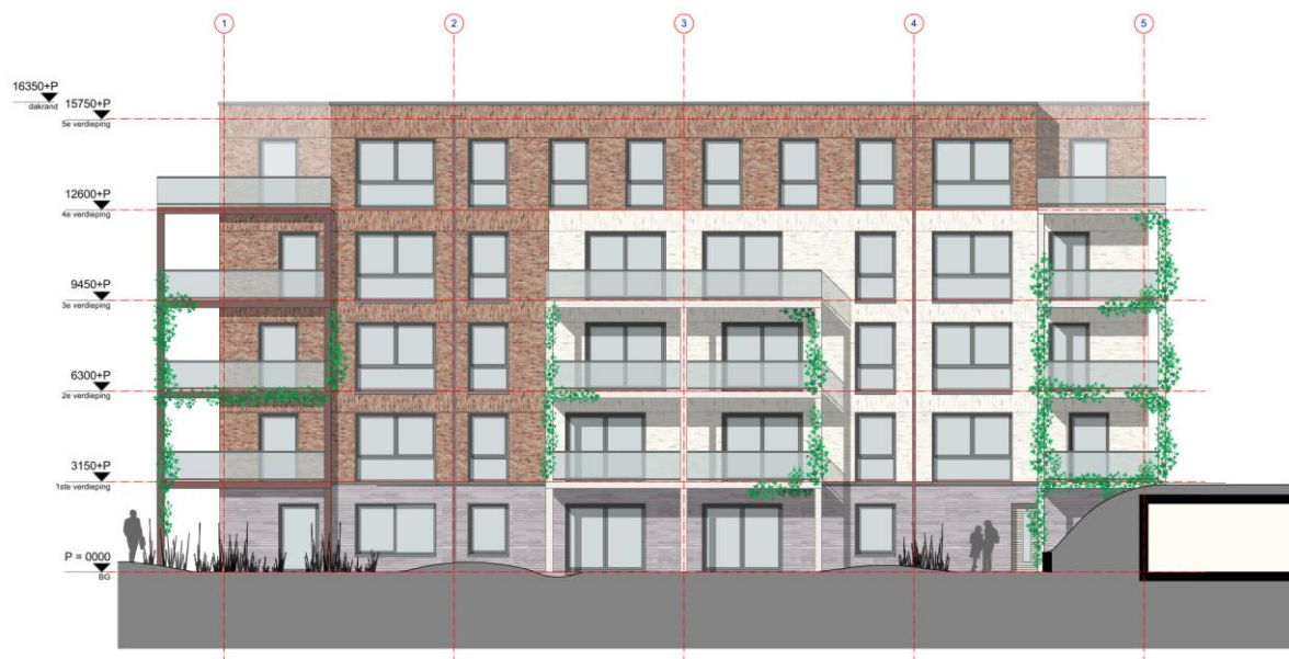
Figuur 3. Aanzicht zuidelijke gevel gebouw A (bron: tekening 2104-2-12-02 van Moke Architecten)
