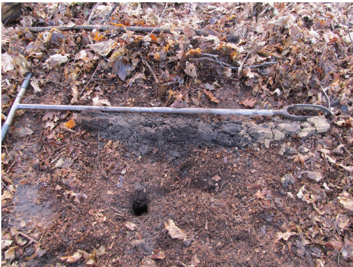
Figuur 5: boring zuidwestzijde Mobilisatiecomplex Bussum, met 70 cm. dikke laag teruggestorte, matig humusrijke grond, fijnzandig, met grondwaterstand op – 80 cm. beneden maaiveld. Foto: RHDHV, 28 jan. 2014
