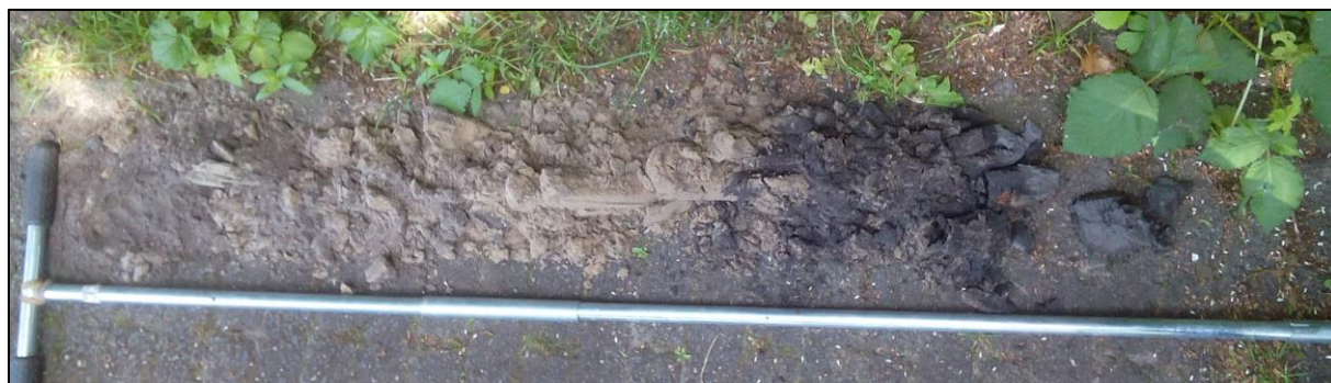
Foto 8: profielboring bodemopbouw nabij verharding.
