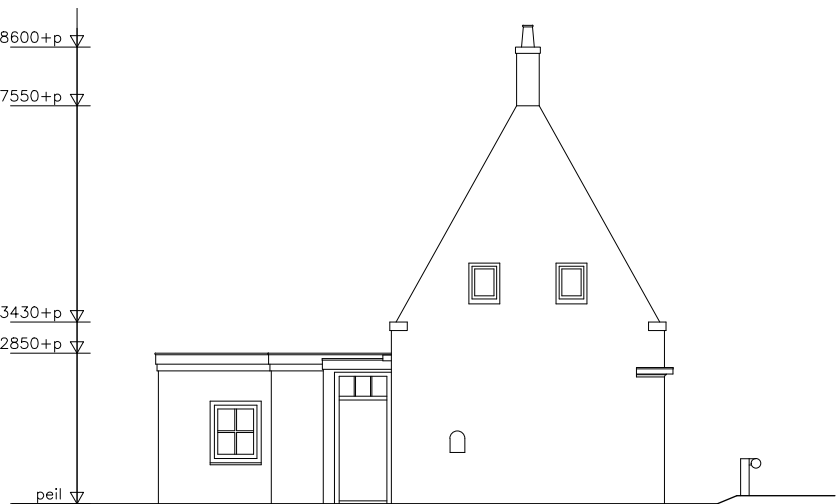
AANZICHT ZIJGEVEL bestaande toestand
