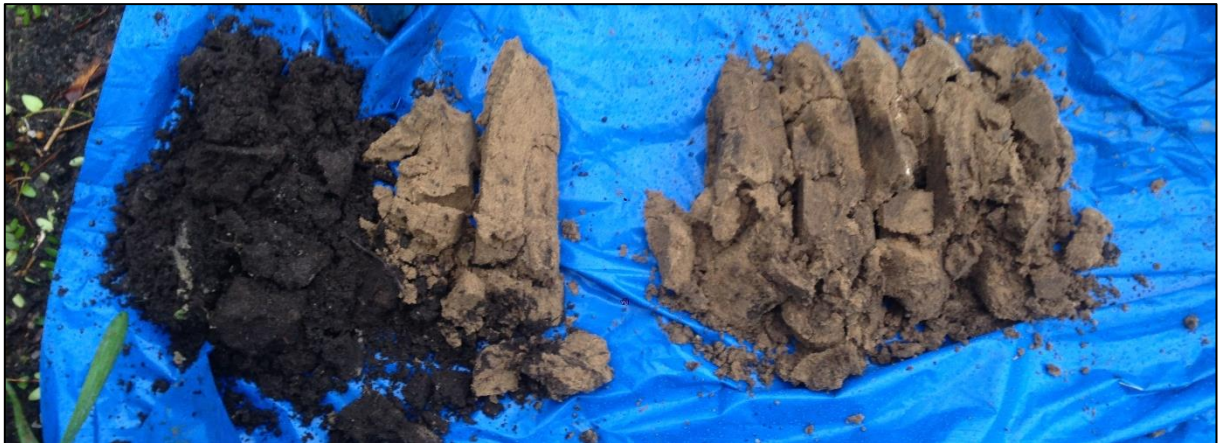
Boring 4: 0-100 cm -Mv. Er is viermaal gepoogd deze boring voorbij 100 cm -Mv te zetten, maar zit is niet gelukt. Hierop is besloten de boring te staken in grof puin of een leiding.
