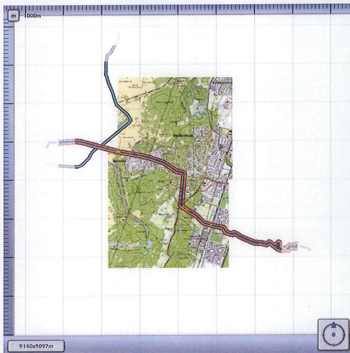
3.2 Figuur 3.2 Plaatsgebonden risico voor W-532-02 van N.V. Nederlandse Gasunie
