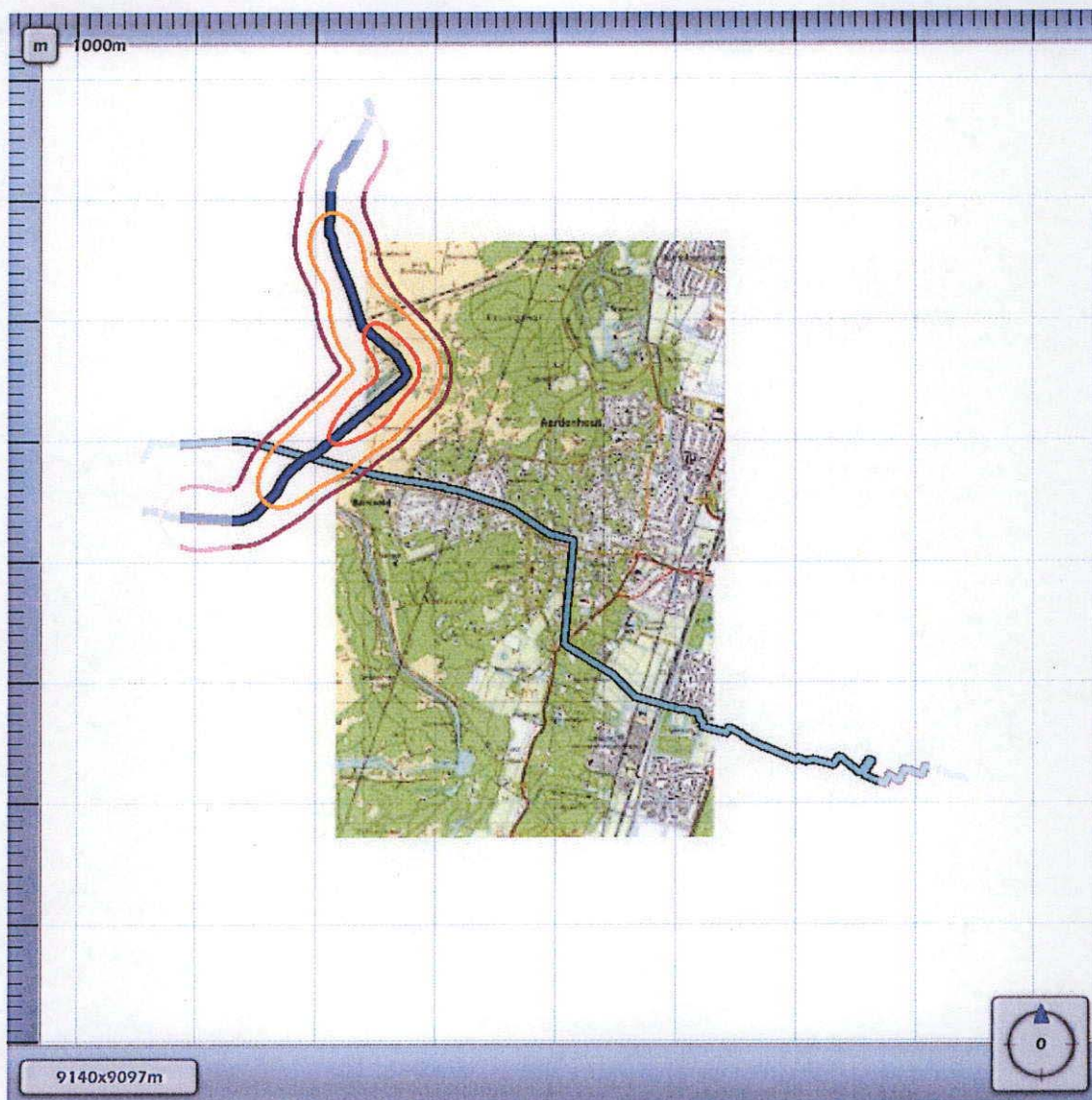
3.1 Figuur 3.1 Plaatsgebonden risico voor A-560 van N.V. Nederlandse Gasunie
