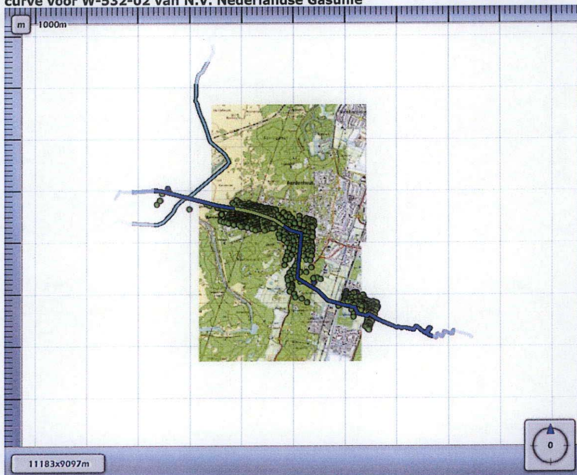
Figuur 4.2 Kilometer leiding behorende bij de maximale overschrijding van de FN-curve voor W-532-02 van N.V. Nederlandse Gasunie
