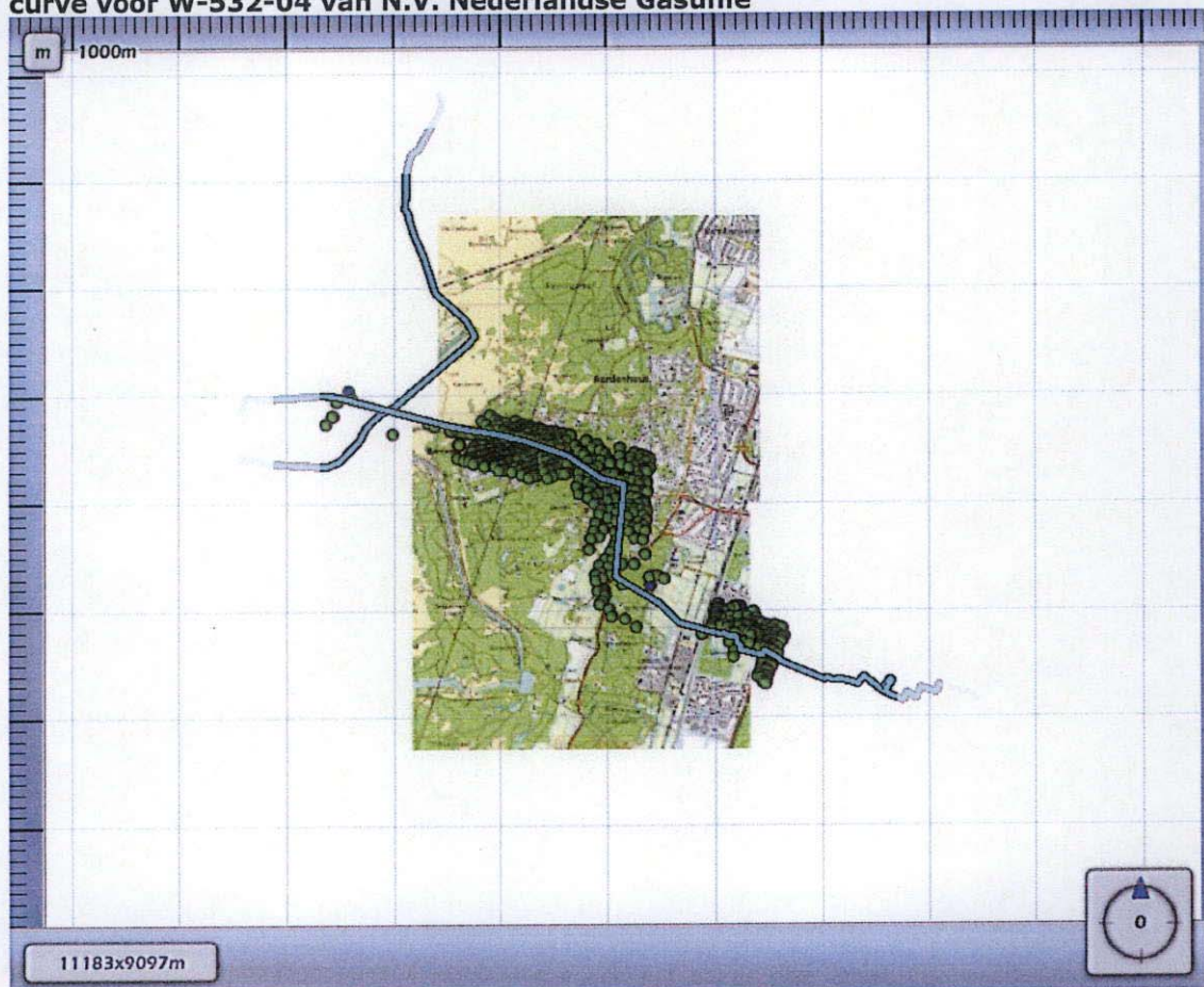
Figuur 4.3 Kilometer leiding behorende bij de maximale overschrijding van de FN-curve voor W-532-04 van N.V. Nederlandse Gasunie
