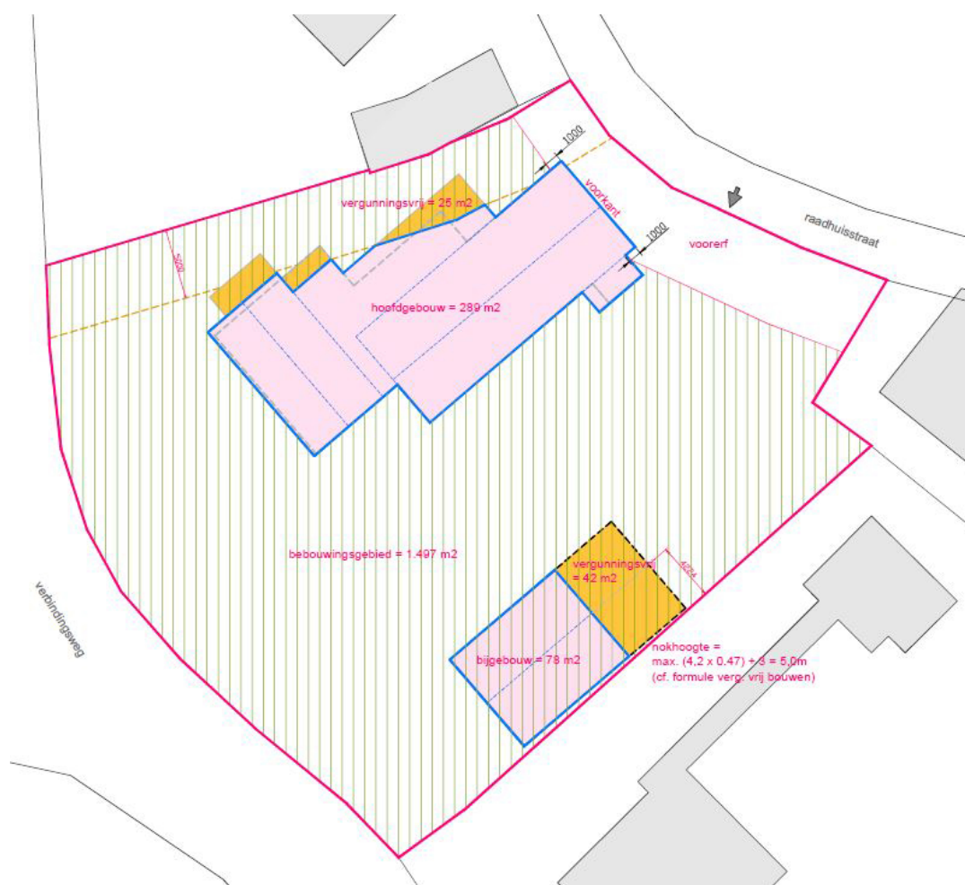
AFBEELDING VOOR BEREKENING VERGUNNINGSVRIJE BOUWWERKEN
