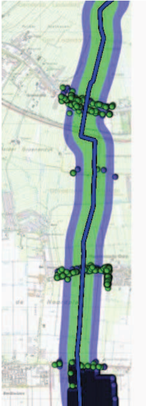
Figuur 10: Ligging van de geprojecteerde gastransportleiding A-803 segment 5 (paragraaf 2.2) stationing 48.9 – 58.4 km. Het PR is overal rond dit segment kleiner dan 10^{-6} per jaar. De blauw en groen gekleurde gebieden markeren respectievelijk de 10^{-7} en 10^{-8} per jaar PR contouren. De gekleurde punten zijn de adressen binnen het invloedsgebied van de leiding, waarbij groen staat voor bewoners en blauw voor werknemers.
