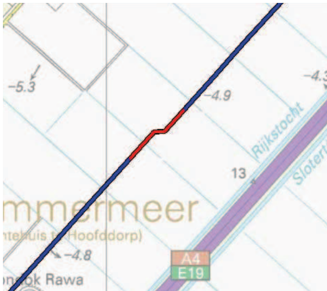
Figuur 4 Het rode deel van de leiding dient te worden met een wanddikte van 22.7 mm om het PR te reduceren tot onder het wettelijke niveau. Dit deel van de leiding loopt van Rijksdriehoekcoördinaten (RD) X:108250 Y: 476650 t/m X: 108075 Y: 476493 dit komt overeen met stationing 30865 t/m 30632 van het tracé Beverwijk - Wijngaarden
