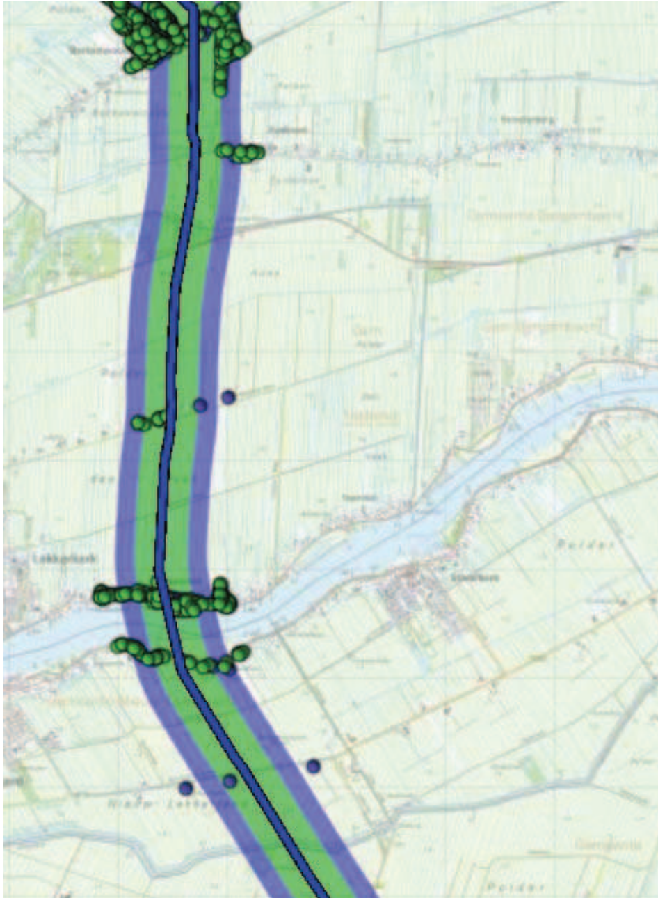
Figuur 13: Ligging van de geprojecteerde gastransportleiding A-803 segment 8 (paragraaf 2.2) stationing 76.5 – 85.9 km. Het PR is overal rond dit segment kleiner dan 10^{-6} per jaar. De blauw en groen gekleurde gebieden markeren respectievelijk de 10^{-7} en 10^{-8} per jaar PR contouren. De gekleurde punten zijn de adressen binnen het invloedsgebied van de leiding, waarbij groen staat voor bewoners en blauw voor werknemers.
