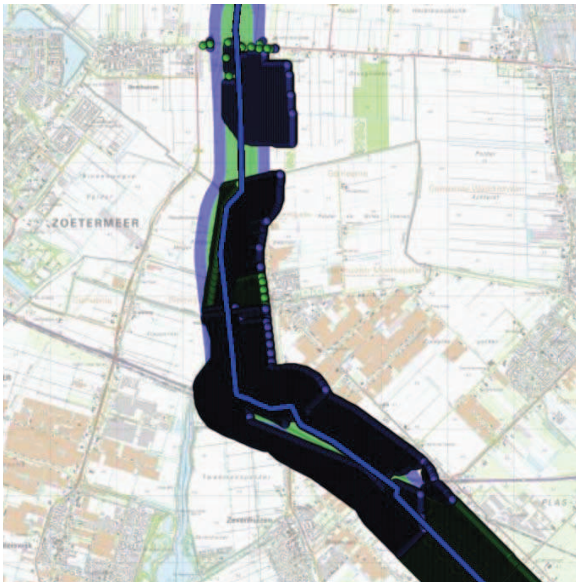
Figuur 11: Ligging van de geprojecteerde gastransportleiding A-803 segment 6 (paragraaf 2.2) stationing 56.7 – 67.9 km. Het PR is overall rond dit segment kleiner dan 10^{-6} per jaar. De blauw en groen gekleurde gebieden markeren respectievelijk de 10^{-7} en 10^{-8} per jaar PR contouren. De gekleurde punten zijn de adressen binnen het invloedsgebied van de leiding, waarbij groen staat voor bewoners en blauw voor werknemers. NB: door de plaatselijk hoge dichtheid van blauwe punten lijken dit zwarte vlakken te worden.
