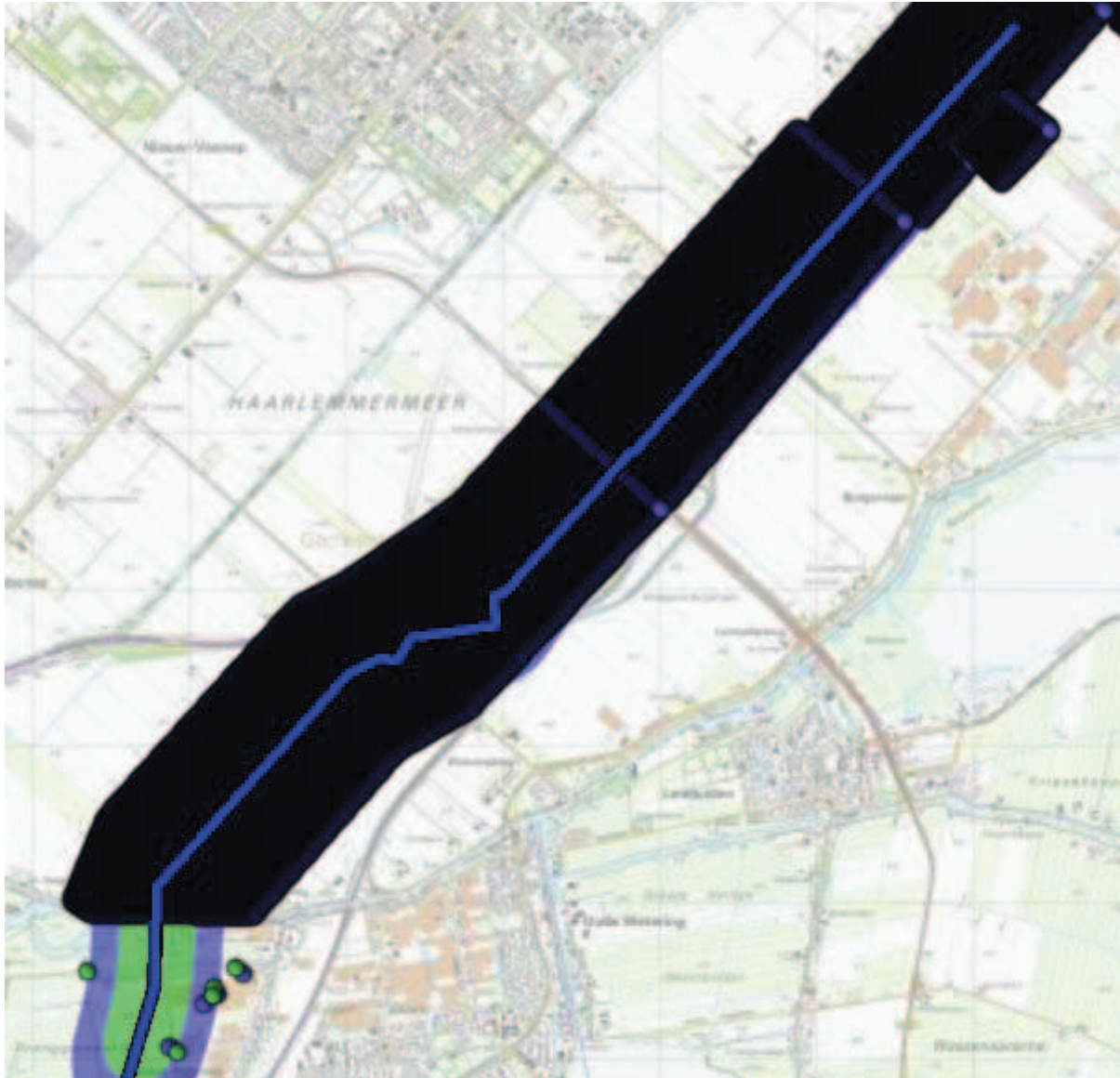
Figuur 8: Ligging van de geprojecteerde gastransportleiding A-803 segment 3 (paragraaf 2.2) stationing 32.1 – 41.3 km. Het PR is overall rond dit segment kleiner dan 10^{-6} per jaar. De blauw en groen gekleurde gebieden markeren respectievelijk de 10^{-7} en 10^{-8} per jaar PR contouren. De gekleurde punten zijn de adressen binnen het invloedsgebied van de leiding, waarbij groen staat voor bewoners en blauw voor werknemers. NB: door de plaatselijk hoge dichtheid van blauwe punten lijkt dit één zwart vlak te worden.
