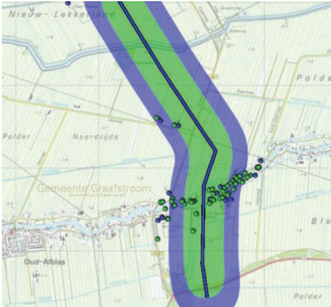
Figuur 14: Ligging van de geprojecteerde gastransportleiding A-803 segment 9 (paragraaf 2.2) stationing 84.0 – 88.2 km. Het PR is overal rond dit segment kleiner dan 10^{-6} per jaar. De blauw en groen gekleurde gebieden markeren respectievelijk de 10^{-7} en 10^{-8} per jaar PR contouren. De gekleurde punten zijn de adressen binnen het invloedsgebied van de leiding, waarbij groen staat voor bewoners en blauw voor werknemers.
