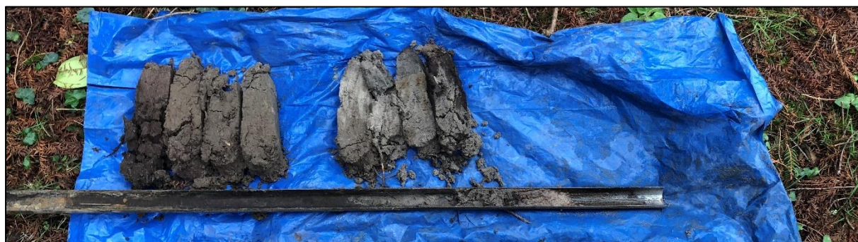
Boring 5: 0-150 cm -Mv. Dieper gelegen duinzand liep uit de boor onder invloed van grondwater. Door veen- en kleirestant is dieper boren met de zuigerboor niet mogelijk.
