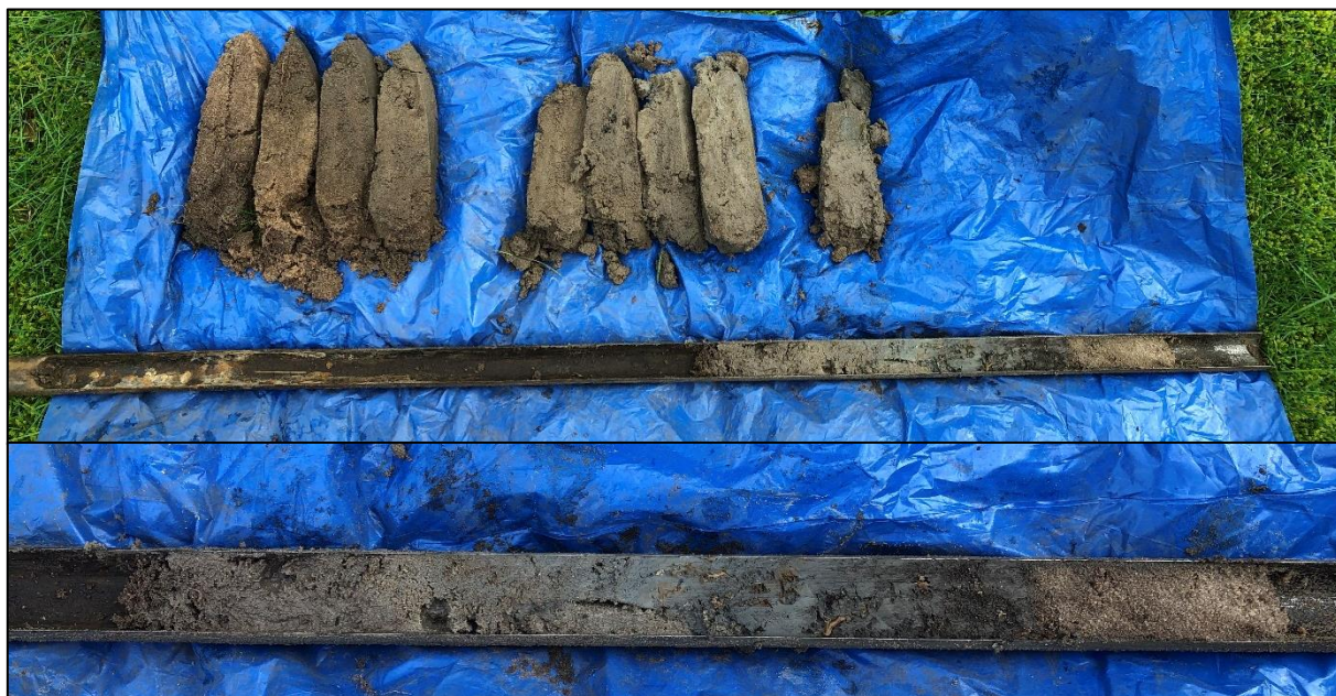
Boring 2: 0-175 cm -Mv inclusief detail van gutsboring met humeuze duintop. Dieper gelegen zand liep onder invloed van grondwater uit de boor. Door de aanwezigheid van kleipakket is boren met de zuigerboor onmogelijk gebleken.
