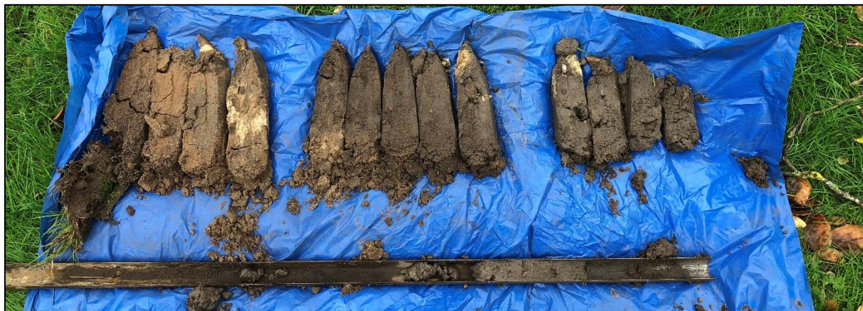
Boring 1: 0-200 cm -Mv. Dieper gelegen sediment liep uit de boor door de grondwaterstand. Door de puinhoudendheid van het pakket bleek boren met een zuigerboor onmogelijk.
