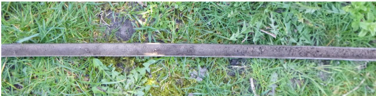
Figuur 16: Foto van het vergraven zandpakket dat bovenin alle boringen is aangetroffen
