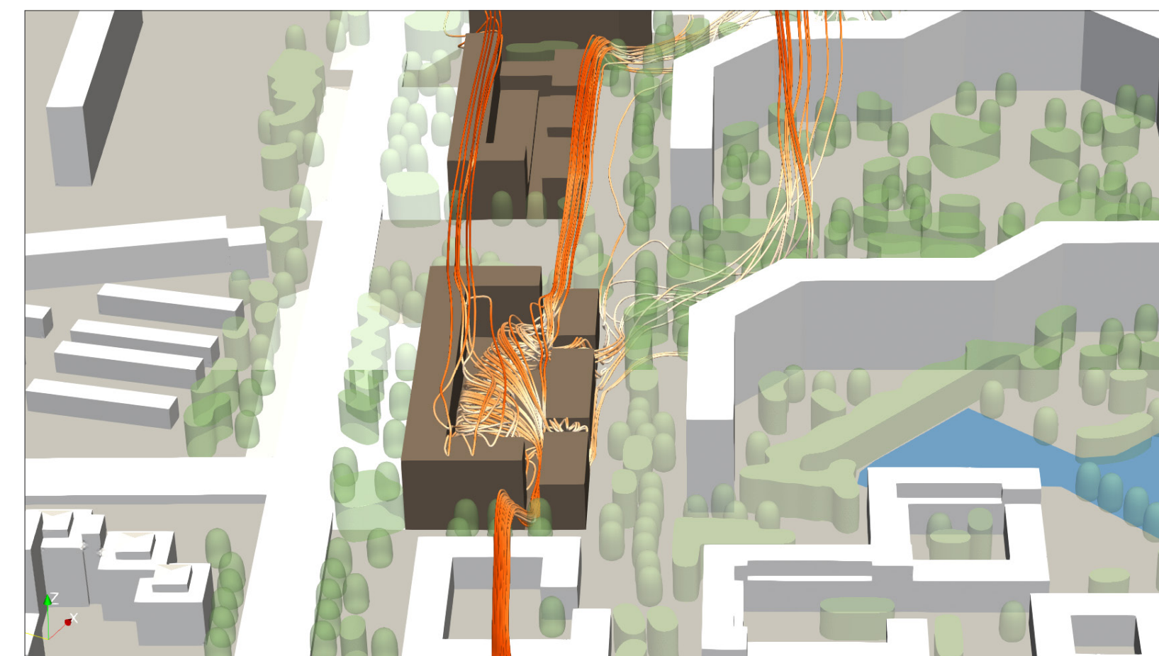
Figuur 5.2: Stroomlijnen blok A zuidwestgevel en binnenplaats
