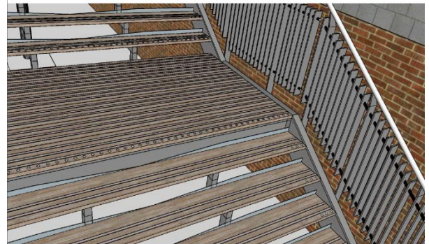
Afbeelding links: zijaanzicht vanaf onderdoorgang Bijlmerdreef; Afbeelding rechts: staaltrap met houten dekplanken
