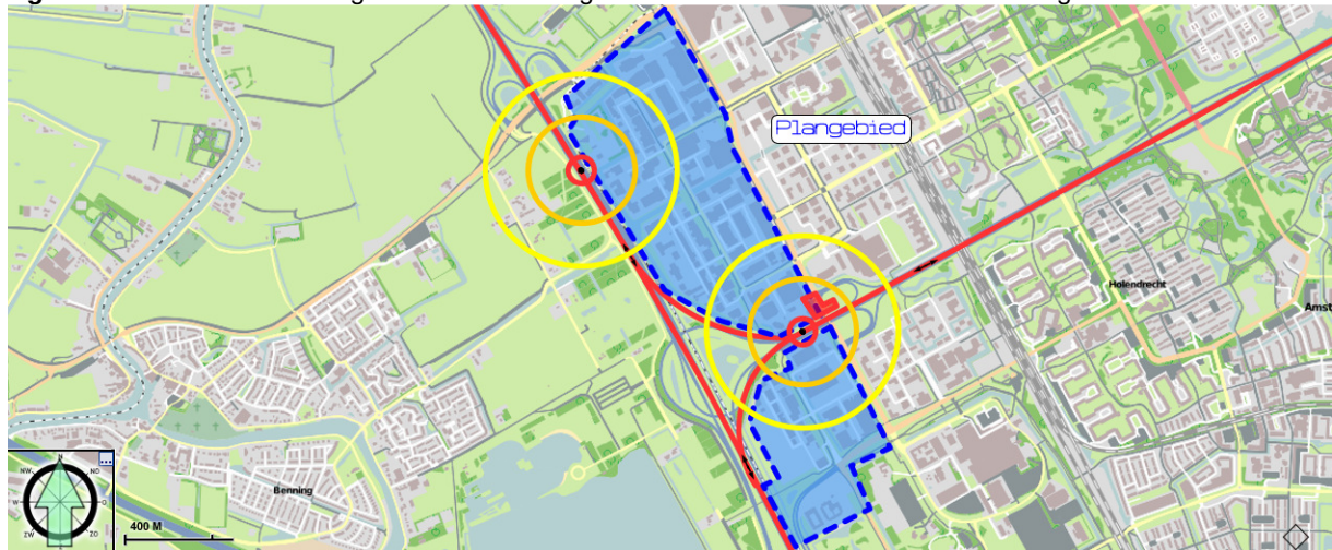
Figuur 2. Schematische weergaven van de effectgebieden na een BLEVE van een tankwagen LPG
