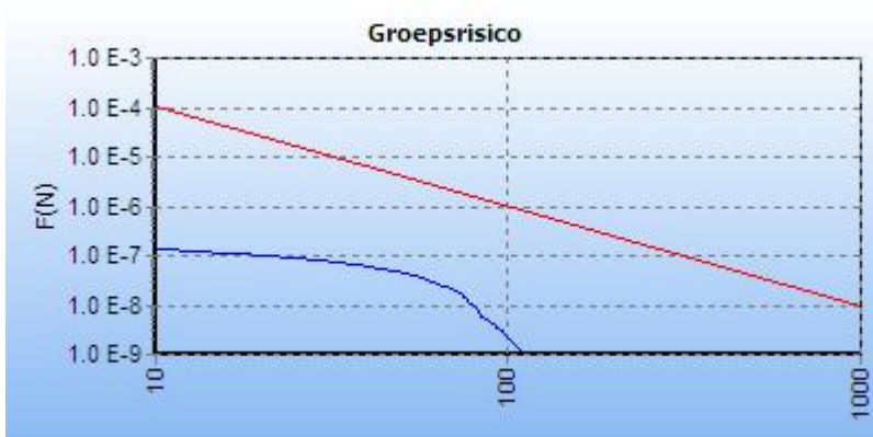
Figuur 5.1 FN curve voor W-534-39 van N.V. Nederlandse Gasunie voor de kilometer tussen stationing 13350.00 en stationing 14350.00
