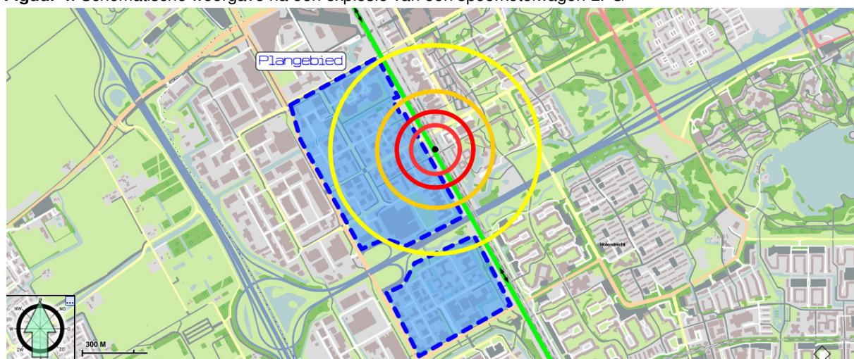
Figuur 4. Schematische weergave na een explosie van een spoorketelwagon LPG
