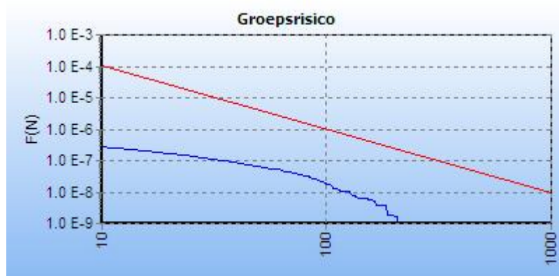
Figuur 5.1 FN curve voor W-534-39 van N.V. Nederlandse Gasunie voor de kilometer tussen stationing 15570.00 en stationing 16570.00
