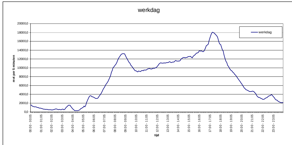
Figuur 2: Verkeersbewegingen op basis van de gecumuleerde vijfminutenintensiteiten van de vijf geselecteerde VRI's voor een gemiddelde werkdag in november waarbij geen sprake is van een evenement binnen het studiegebied.
