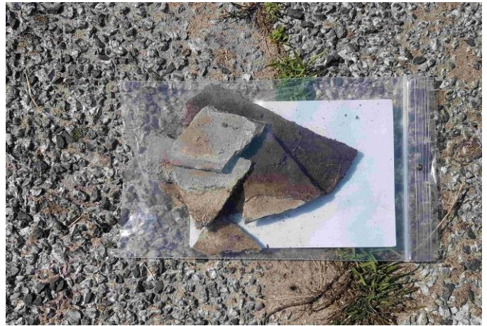
Foto 10: asbestverdacht materiaal SL42
