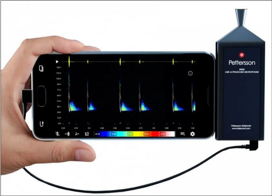
Figuur 4: Peterson M500-384 batdetector in combinatie met een Motorola Moto E5 Smartphone.
