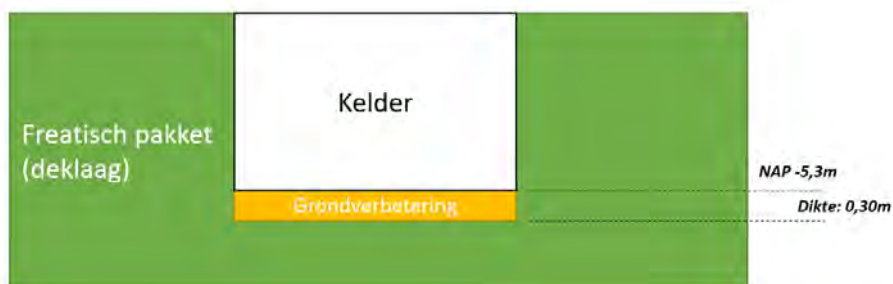
Figuur 5 Schematische doorsnede freatisch pakket na de werkzaamheden.
