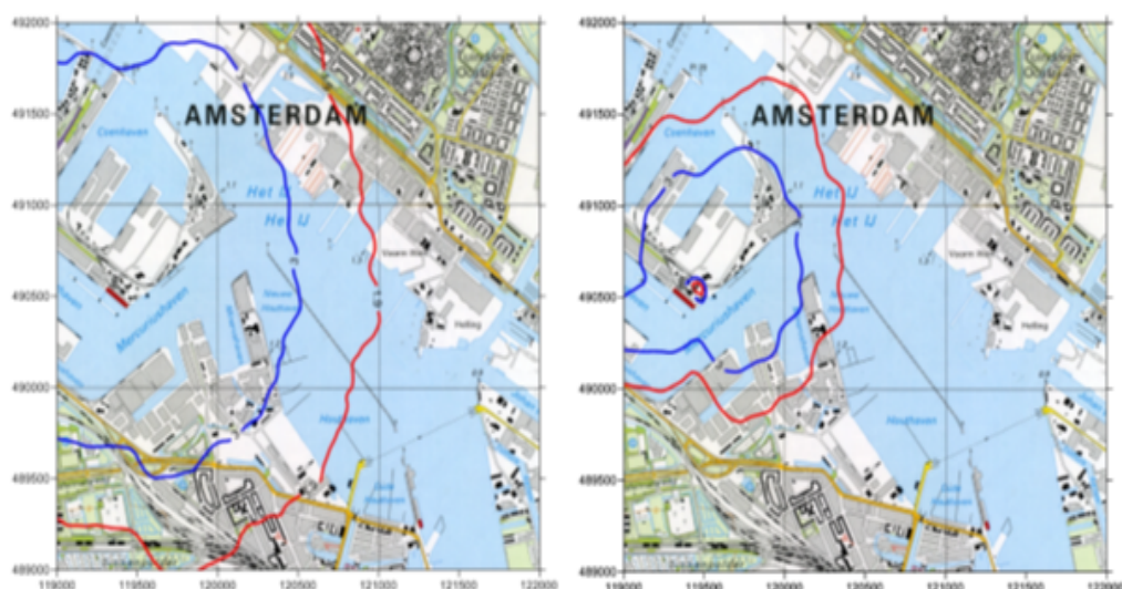
Geurcontouren van 1,9 en 3,0 ouE/m 3 als 98-percentielwaarde als gevolg van Cargill Soja in de situatie zonder en met MBTF-geurinstallatie.
