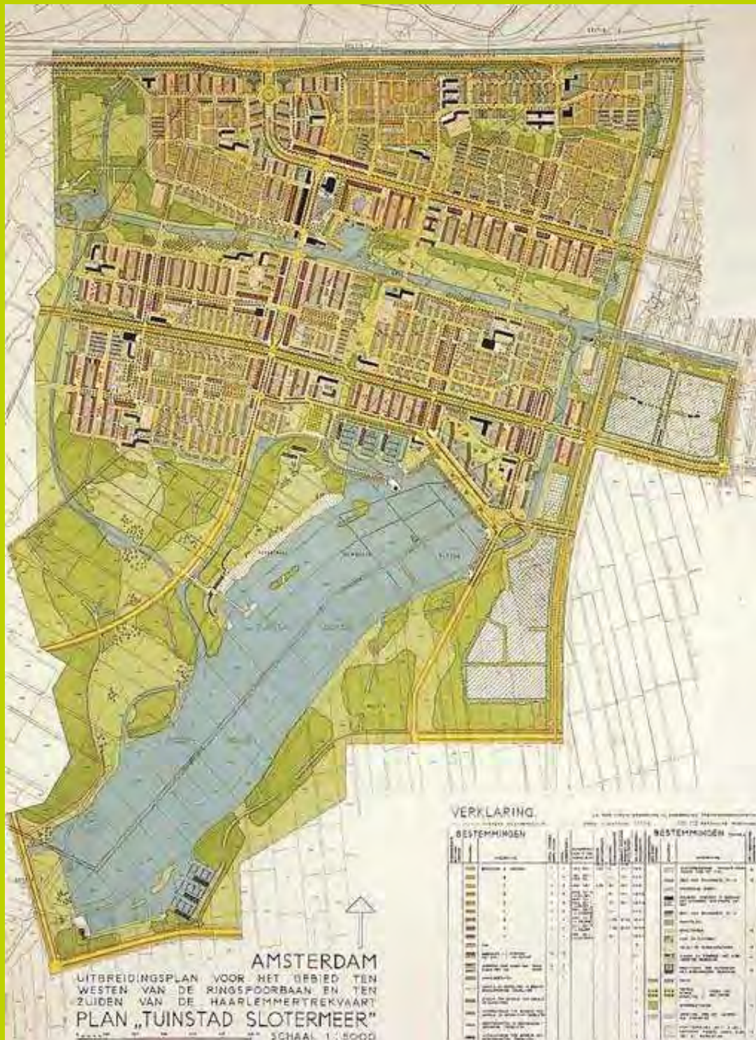
Vastgesteld ontwerp Sloterveer, 1939. De stroken zijn parallel dan wel loodrecht op elkaar georiënteerd. De tekening benadrukt de groene ruimte rondom de woningen (afbeelding uit V. van Rossem 2001, p. 21).
