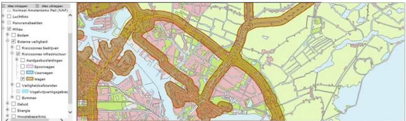
Figuur 1 - Zone 200 meter t.g.v. transport over de weg
