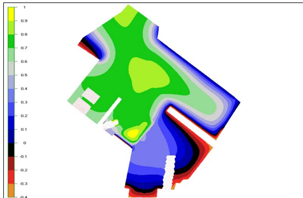
Figuur 12: Berekende grondwaterstand (m NAP) scenario 2.1 met het wensbeeld voor de oevers en minimaal aantal kelders. Kelders (en dokken) zijn in de afbeelding zichtbaar als de vierhoekige, niet-opgevulde vlakken.
