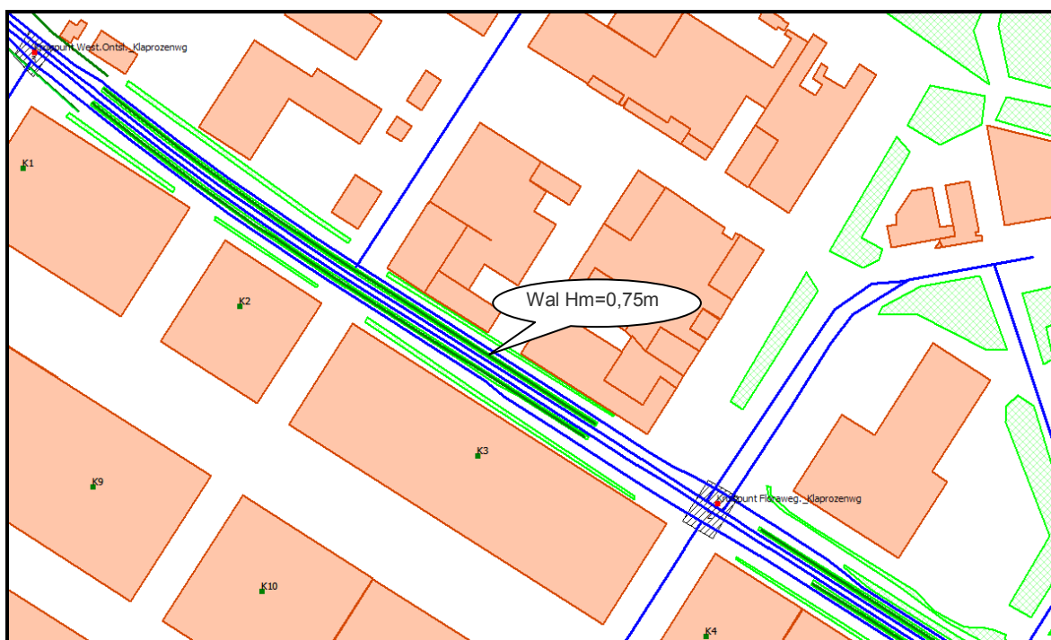
Figuur 14 Wallen, H_m = 0,75\text{m} , op groenstroken aan weerszijde van de busbanen
