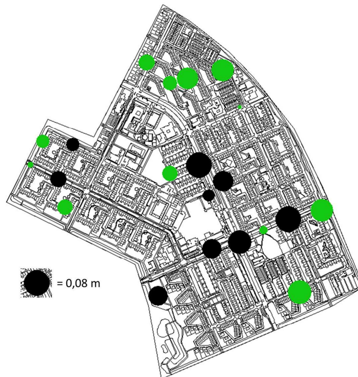
Figuur 8: Resultaat ijking grondwatermodel. Bij de zwarte stippen is de berekende grondwaterstand hoger dan de gemeten waarden, bij de groene stippen is de berekende grondwaterstand lager dan de gemeten waarde.
