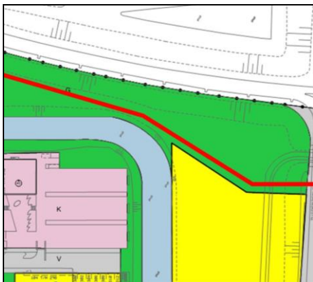
Afbeelding: tracé rioolpersleiding
