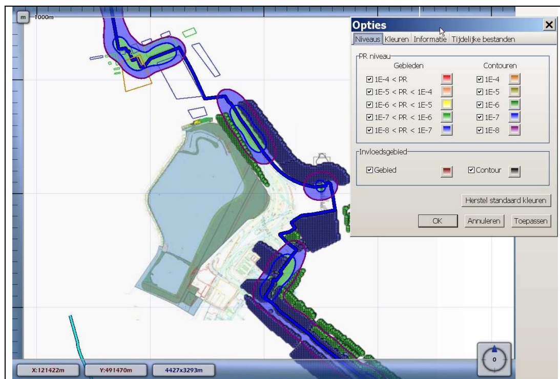
Figuur 4: Weergave van het plaatsgebonden risico voor leiding W-572-01
