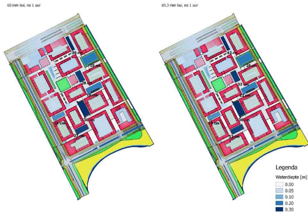
Figuur 3-4: Voorbeeld van 2 conceptberekeningen met buien van verschillende intensiteit
