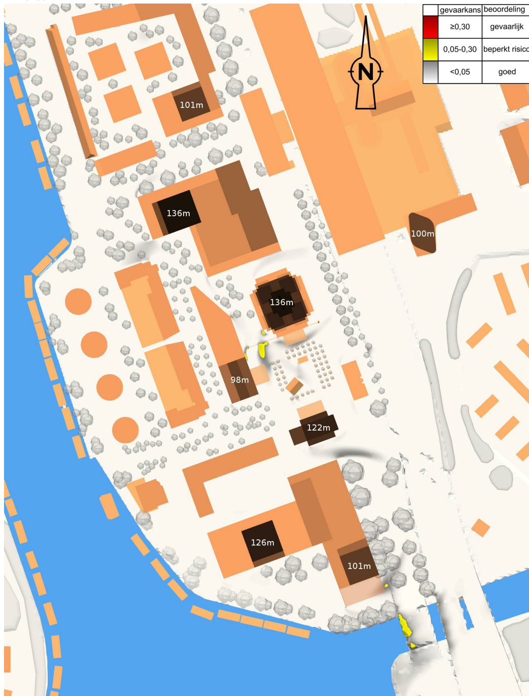
f3.11 Windgevaarkans in de geplande bebouwingssituatie met gehandhaafde en geplande bomen, beoordeeld volgens de NEN 8100
