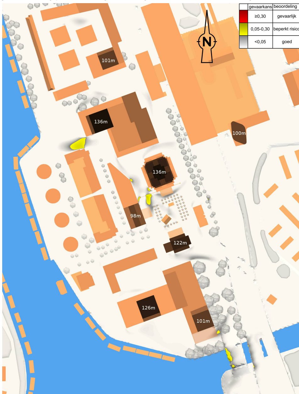
f3.7 Windgevaarkans in de geplande bebouwingssituatie met gehandhaafde bomen, beoordeeld volgens de NEN 8100
