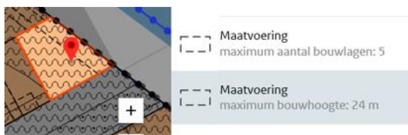
Bouwvlak met maximale bouwhoogte 24 meter en maximum aantal bouwlagen 5.
