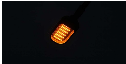
Figuur 5.4. De batlamp is zo ontworpen dat het licht nauwelijks opvalt voor vleermuizen en goede verlichting biedt voor mensen.
