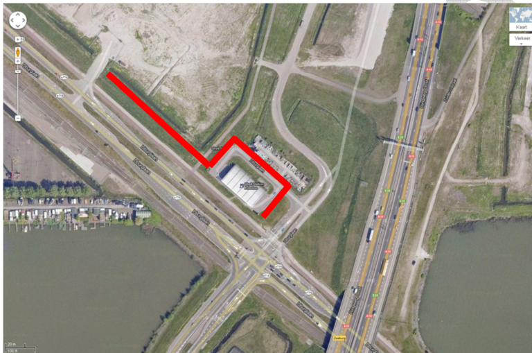
Figuur 2 Ligging grindkoffer Bedrijvenstrook (in rood) ten bate van de grondwaterbeheersing
