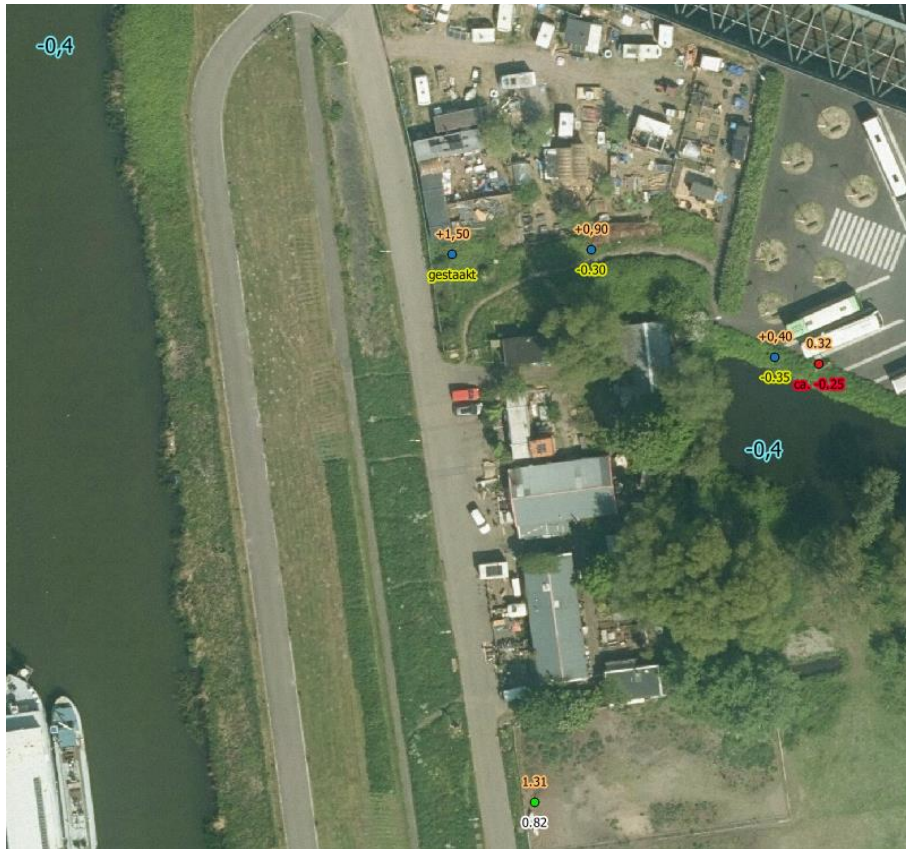
Figuur 7: Peil oppervlaktewater is weergegeven in blauw. Waternet peilbuis Do8033 is aangegeven in groen met het maaiveld (oranje) en GHG (wit), geplaatste peilbuis in rood en boringen in blauw met maaiveld (oranje) en momentopname grondwaterstand (geel)
