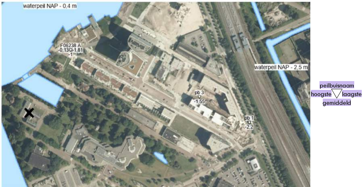
figuur 4 - grondwaterstanden t.o.v. NAP [m] in watervoerende laag 1 (freatisch)
